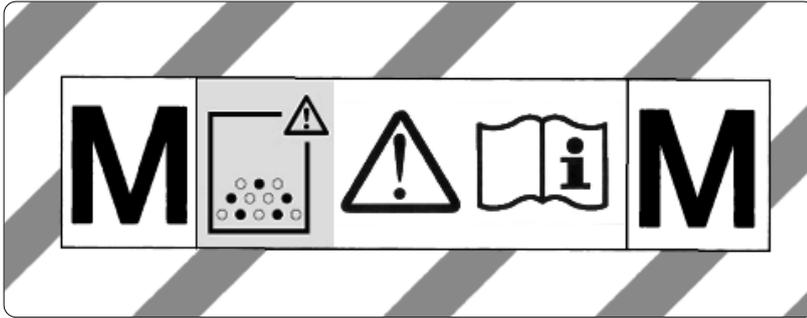
**I** **ATTENZIONE:** Questo apparecchio contiene polveri nocive alla salute. Le operazioni di svuotamento e di manutenzione, inclusa la rimozione del sacchetto della polvere possono essere eseguite solo da personale specializzato indossando un equipaggiamento adatto alla protezione personale. Non attivare prima della completa installazione del sistema di filtraggio ed il controllo del funzionamento dell'unità di controllo del flusso del volume.
