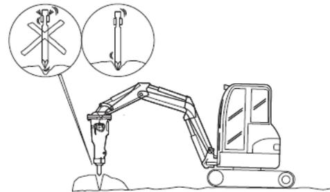
Non fare mai lavorare il demolitore con i cilindri del braccio a fine corsa, questo può provocare danni alla macchina portante
