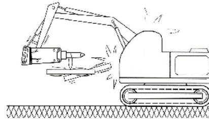
Evitare corse minime, perché possono causare usura del perno ferma utensile e dell'utensile
