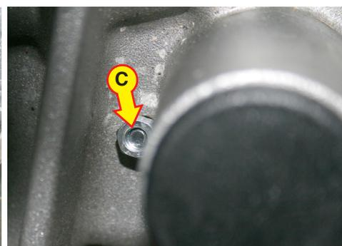
Porre la macchina in posizione orizzontale, se l'utensile è installato, procedere alla rimozione; (per questa operazione, fare riferimento a quanto riportato nel paragrafo "3.3 Montaggio"). Inserire la bocca aspirante (A) all'interno dell'apposito alloggiamento (B). Bloccare la bocca aspirante con le apposite viti (C). Rimontare il planetario motorizzato.
