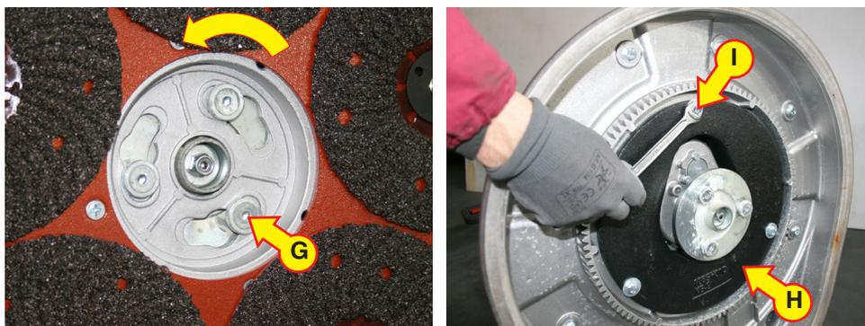
Porre la macchina in posizione orizzontale, afferrare l'utensile e ruotarlo in senso antiorario disimpegnandolo così dai perni (G) della flangia. Se l'operazione di sgancio dell'utensile risultasse insufficiente, bloccare l'albero motore inserendo la chiave di corredo nella cava esagonale situata al di sotto del copriventola. Se si vuole rendere la macchina ulteriormente più leggera, è possibile smontare la zavorra centrale (H), svitando le viti di fissaggio (I).
