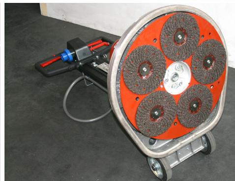
Inserire l'utensile (N) sul mozzo della flangia con attacchi rapidi; ruotarlo in senso orario, fino a che i perni (P) della flangia si inseriscono nella flangia del planetario motorizzato (Q). terminato l'innesto, riposizionare la macchina verticalmente.
