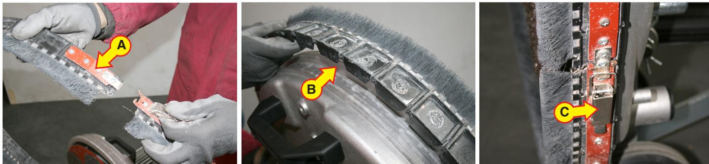
Porre la macchina in posizione orizzontale; posizionare l'anello per aspirazione (A) sulla gomma paracolpi (B) e verificare che sia parallelo alla gomma paracolpi e quindi bloccarlo per mezzo dell'apposito moschettone (C). Riposizionare la macchina verticalmente e regolare l'altezza dell'anello.
