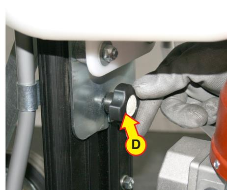
Posizionare l'impugnatura in posizione di massima alzata allentando la maniglia (A). Posizionare la linguetta (B) all'interno della cava (C). Bloccare la posizione del serbatoio tramite il pomello (D).
