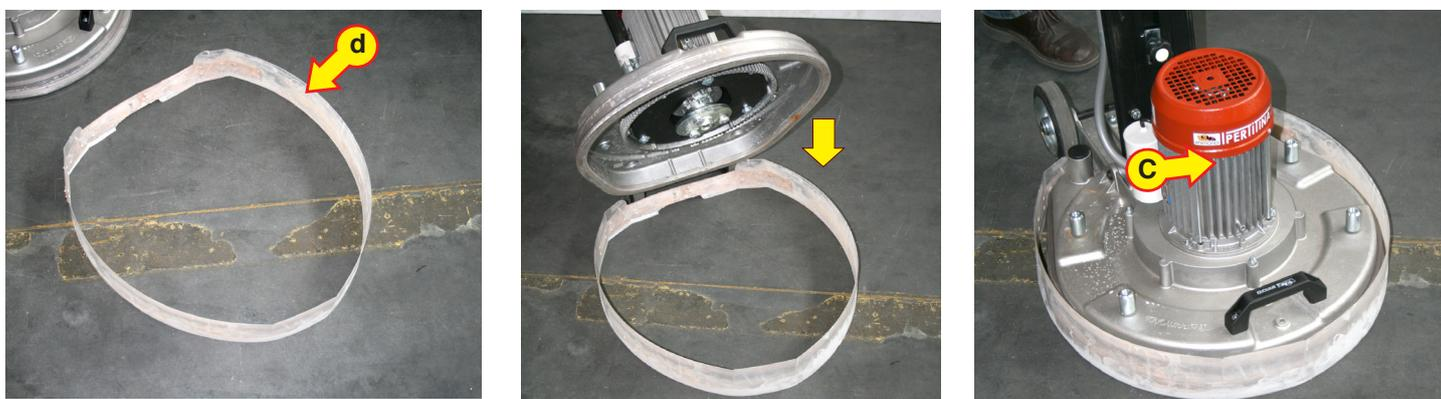
Porre la macchina in posizione orizzontale ed infilarla all'interno dell'anello paraspruzzi (D). Riportare la macchina in posizione verticale.
