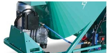
Compressore a membrane fissato a bordo macchina.
