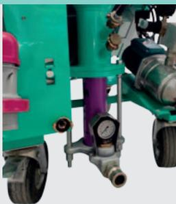
Flangia di mandata materiale in ghisa con misuratore di pressione. Connessione diretta per tubo DN35 F. Permette di estendere le tubazioni fino a 50 m di distanza, riducendo al minimo le usure del gruppo statore-vite. La riduzione per applicare il tubo DN 25 è inclusa nell'equipaggiamento di serie.
