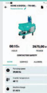
Interconnessione IoT via Bluetooth con lo smartphone dell'utilizzatore tramite l'app IMER CONNECT scaricabile gratuitamente da Google Play o App Store. L'interconnessione permette di monitorare lo stato della macchina in ogni momento, mantenere sotto controllo le ore di funzionamento e molti altri parametri, utili alla ricerca di eventuali anomalie di funzionamento, condivisibili via SMS con il Servizio Assistenza IMER.
