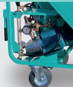
Nuova disposizione della pompa acqua e delle componenti idrauliche studiata per migliorare il drenaggio dell'acqua nei periodi invernali. Elettropompa autoadescante di generose dimensioni, capace di 4,5 bar di pressione. Antibloccaggio per effetto dell'ossidazione, grazie alla calotta in acciaio inox e girante in ottone.
