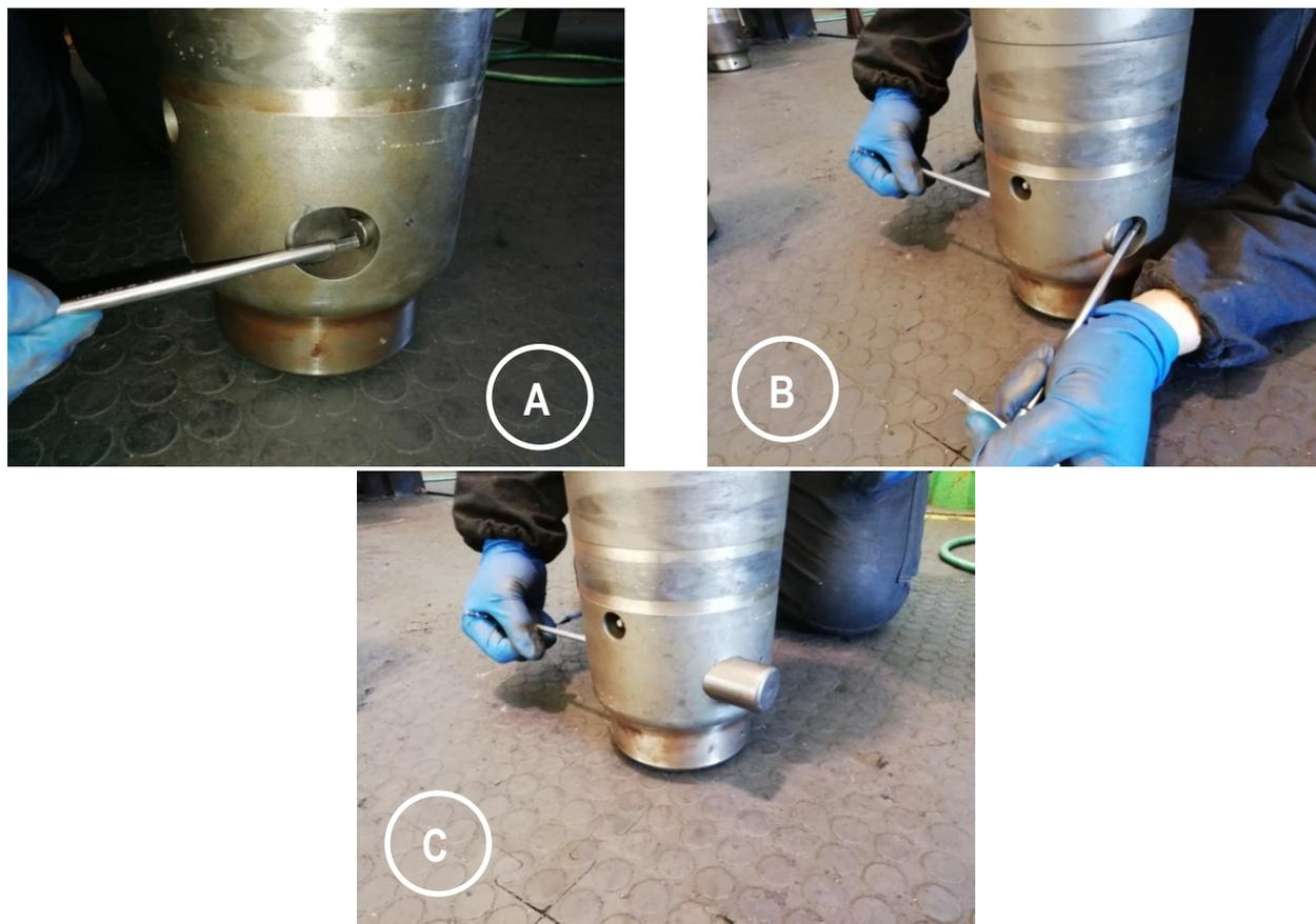
**Figura 8:** Sostituzione utensile
