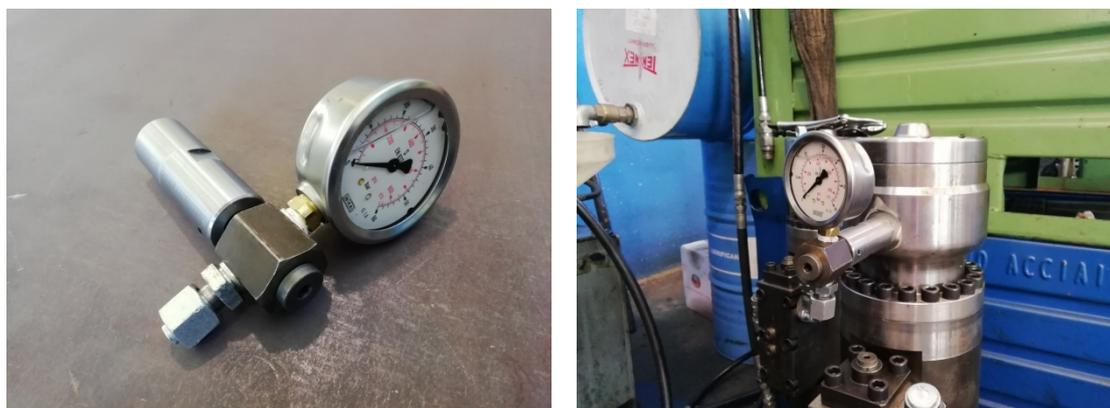
**Figura 7:** Particolari attrezzo per verifica pressione e ricarica
