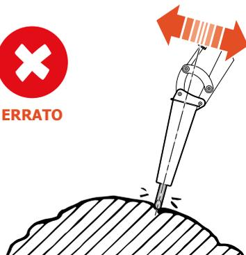
Non operare con il martello idraulico per più di un minuto nello stesso punto, poiché si rischia di logorare la punta e/o l'idraulica, se l'oggetto non viene rotto dopo un minuto, posizionare la punta in altre zone.
