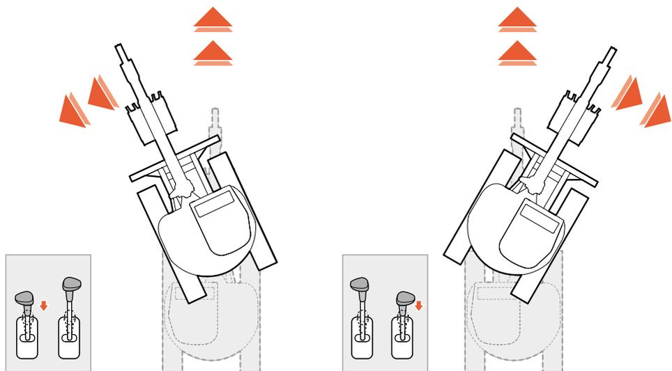
Quando la macchina si sposta in direzione rettilinea in **AVANTI** entrambe le leve di comando devono essere spinte in avanti nella stessa misura.
