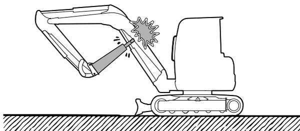
Non utilizzare il martello idraulico con il secondo braccio posizionato in verticale; eccessive vibrazioni al cilindro del secondo braccio possono causare perdite d'olio.
