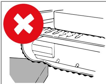
Evitare che corpi estranei si vadano ad incastrare tra il cingolo ed il telaio o i componenti del sottocarro, se questo accade tutto il sottocarro può subire dei danni ed il cingolo si potrebbe deformare e/o tagliare.
