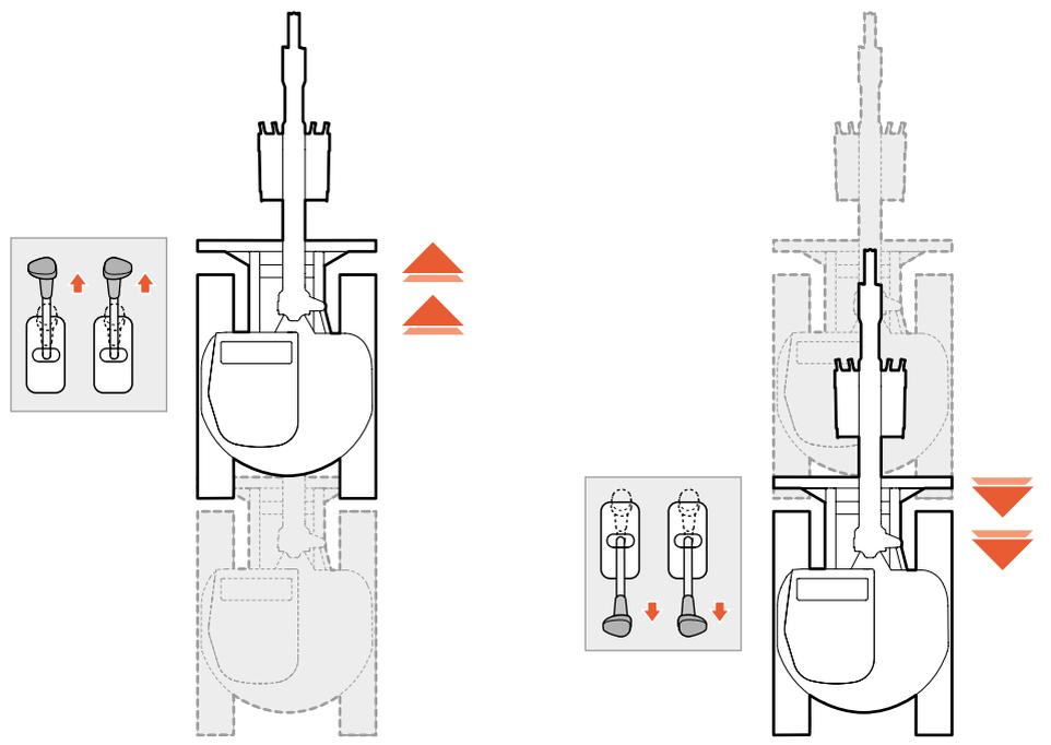
Per avviare la marcia in **AVANTI**, applicare il movimento di avanzamento nella stessa misura su entrambe le leve di comando. Aumentando lo spostamento, aumenta anche la velocità della macchina. Per **ARRESTARE** la marcia in **AVANTI** riportare entrambi i comandi in posizione **NEUTRA (N)**.
