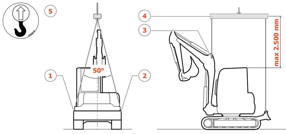
Le istruzioni per il sollevamento sono semplificate e schematizzate in un'apposita etichetta operativa (6) posizionata sulla macchina.
