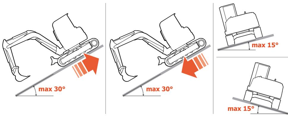
**Quando ci si sposta su un terreno ripido con pendenza inferiore a 15°**, ridurre sempre la velocità della macchina e spostarsi in maniera lenta e lineare. Frenare facendo ritornare dolcemente le due leve di comando della traslazione in posizione NEUTRA (N).
