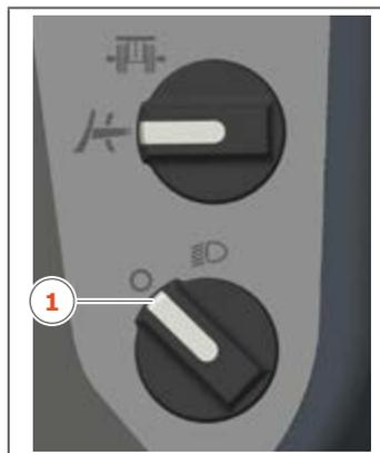
Sulla macchina possono essere installati anche dei fari optional che saranno posizionati sul tetto della struttura di protezione, hanno la funzione di fornire un'illuminazione maggiore rispetto al faro standard. I fari optional vengono comandati con lo stesso interruttore del faro standard per cui avranno lo stesso funzionamento.
