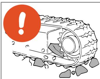
I corpi sporgenti, se possibile, vanno aggirati. Se questa manovra non è possibile, procedere con cautela a bassa velocità ed in marcia rettilinea evitando di sterzare quando il cingolo si trova sopra all'ostacolo.
