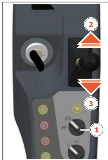
Se si disattiva il selettore (1) prima che la leva di comando ritorni in posizione neutra (al centro) si ottiene l'immediata sostituzione della funzione regolazione larghezza sottocarro con la funzione regolazione altezza lama reinterro.
