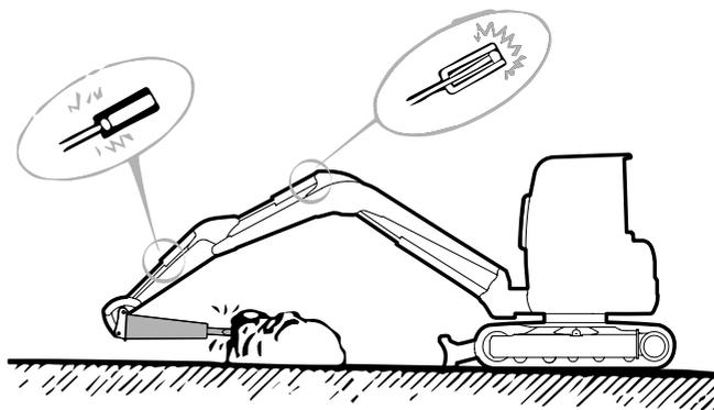
Non operare con il martello idraulico posizionato lateralmente; la macchina risulterebbe instabile ed i componenti del sottocarro soggetti ad usura più rapida.
