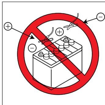
Fare attenzione a non commettere errori durante il collegamento di un cavo supplementare. Nell'ultimo collegamento (al telaio della torretta) si genera una scintilla, quindi collegare il cavo il più lontano possibile dalla batteria (evitare le attrezzature di lavoro, in ogni caso, perché non sono buoni conduttori).
