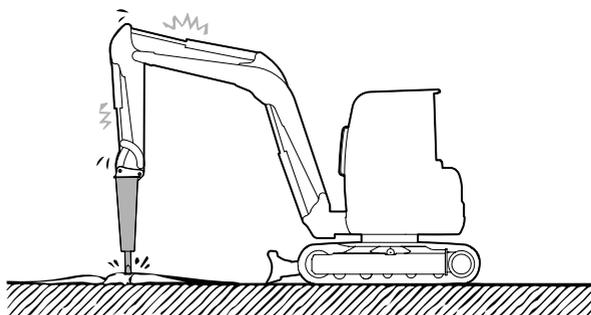
Applicare con il braccio una forza nella stessa direzione della punta in fase di avvicinamento all'oggetto da demolire, durante la demolizione, allontanamento dall'oggetto.
