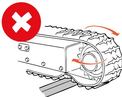
Non sterzare bruscamente quando ci si sposta su superfici con un elevato coefficiente di attrito (es. superfici in cemento), questo potrebbe causare un'eccessiva usura del cingolo.
